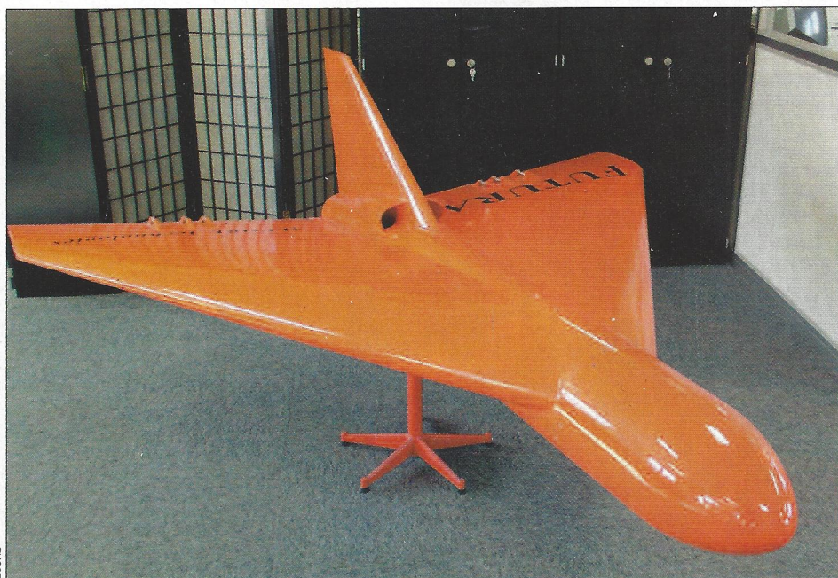
Le Futura d'Alcore peut atteindre une vitesse maximale de 360 km/h.
