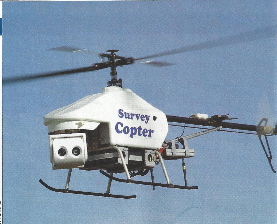
Le CopterCity de Surveycopter : 1,6 m de long et 12 kg au décollage.
