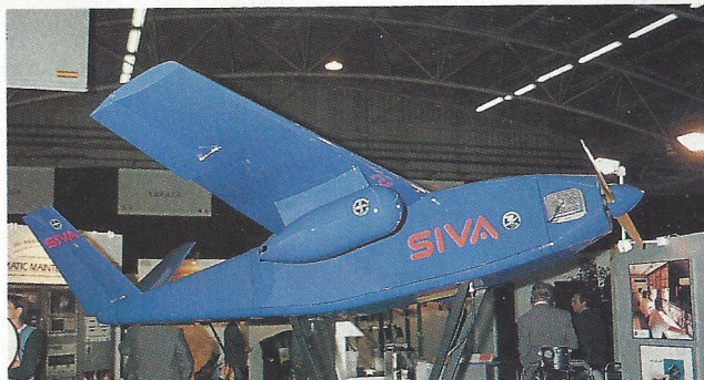
Le SIVA de 3,8 m de long et 4,8 m d'envergure pèse 200 kg avec une charge de 40 kg et vole à 150 km/h. L'autonomie peut atteindre 10 h.
