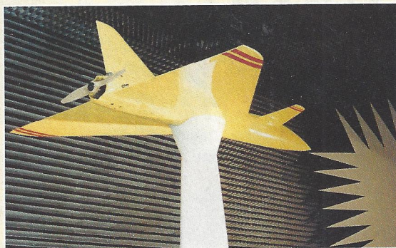
Caractérisation du RPV Chacal en chambre sourde
