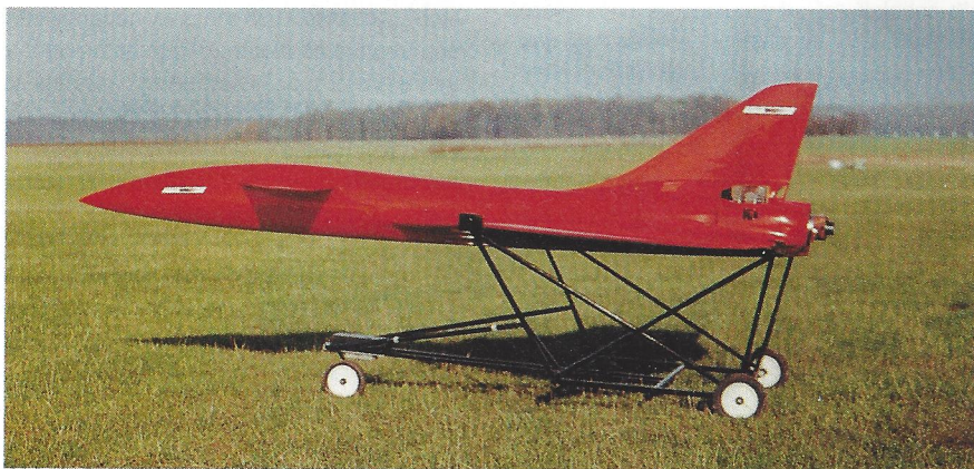
Le Chacal mesure 3m de long avec une voilure delta et pèse 100 kg.
