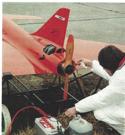
Le RPV est propulsé par moteur rotatif de 216 cm 3 .
