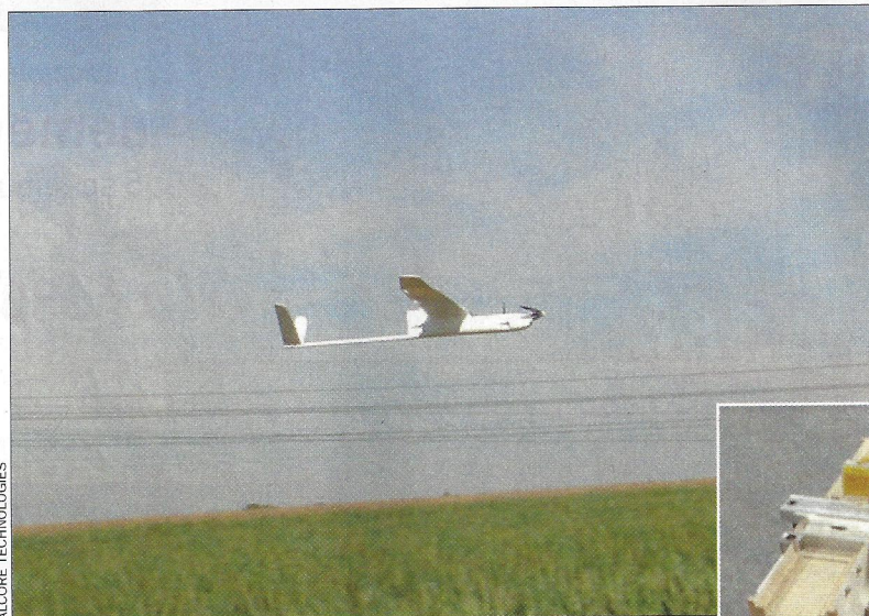
L'Azimut PAC, 6 kg au total, a une envergure de 2,9 m. Il peut emporter une caméra infrarouge haute résolution.
